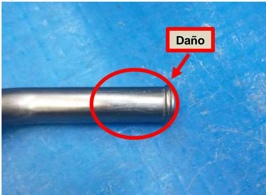
A pesar de que se presentó este problema con la pieza, el tiempo ciclo de la operación en esta máquina se logró disminuir por lo que solo faltaría ajustar una de las velocidades para eliminar el defecto que se está presentando en la pieza.
