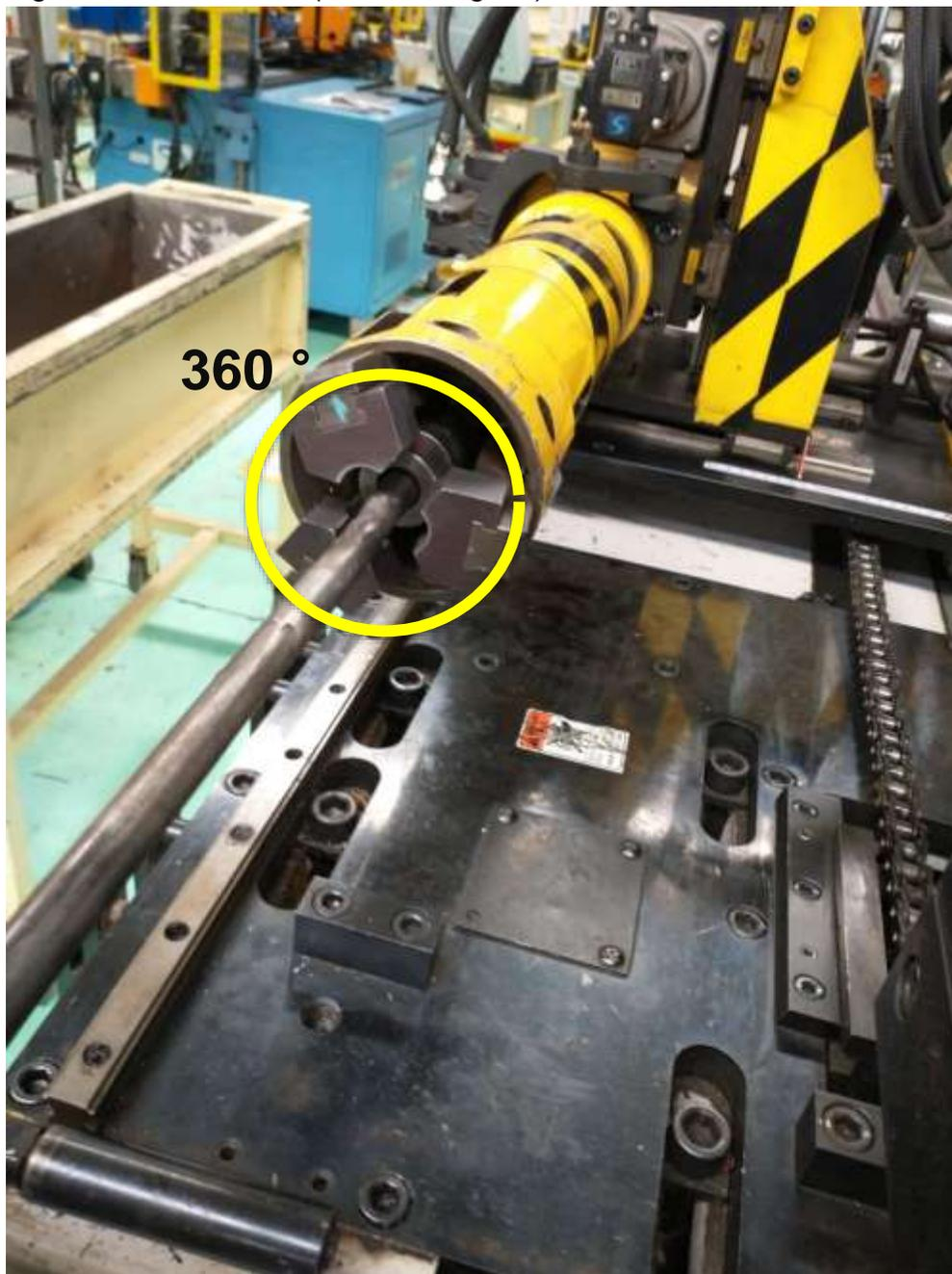
El siguiente componente, se llama brazo, este se encarga de prensar contra el rodillo la pieza, para poder ir realizando los dobleces. Ver Figura 4.18
